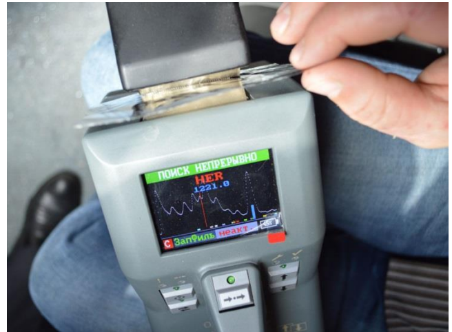
Analyse des particules sur une serviette d'échantillonnage — détection des traces d'héroïne
